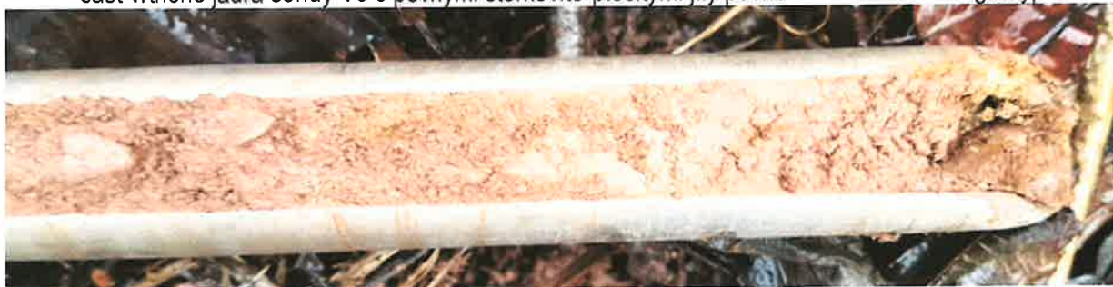
část vrtného jádra sondy V3 s pevnými šterkovito-písčitými jíly pevné konzistence – III. geotyp
