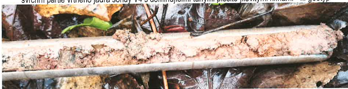
svrchní partie vrtného jádra sondy V4 s dominujícími tuhými písčito-jílovitými hlínami - II. geotyp
