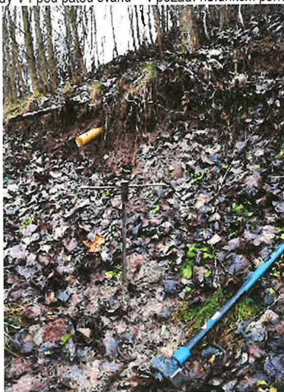
svrchní partie vrtného jádra sondy V4 s dominujícími tuhými písčito-jílovitými hlínami - II. geotyp
