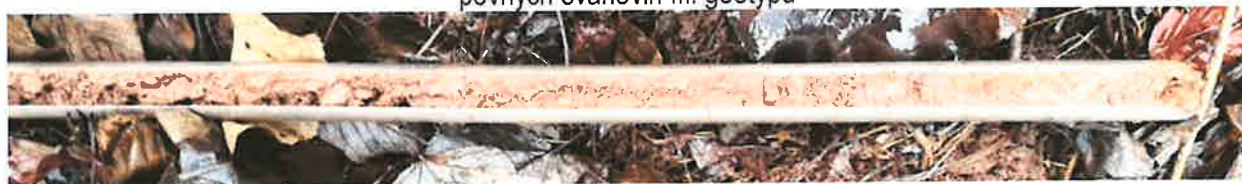
část vrtného jádra sondy V5 – vlevo svrchní partie s tuhými zeminami II. geotypu přecházejícími do pevných svahovin III. geotypu
